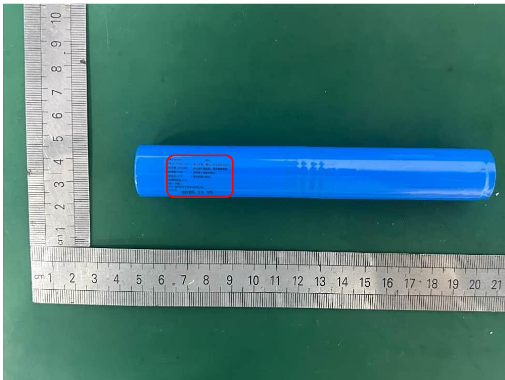
图一 电池组外观 (红框所示为电池组标签位置)
